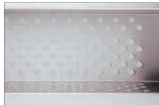
Noppenblech: Zwischen den Noppen entsteht ein Luftpolster, auf welchem das Produkt widerstandslos zum Messer geführt wird.
